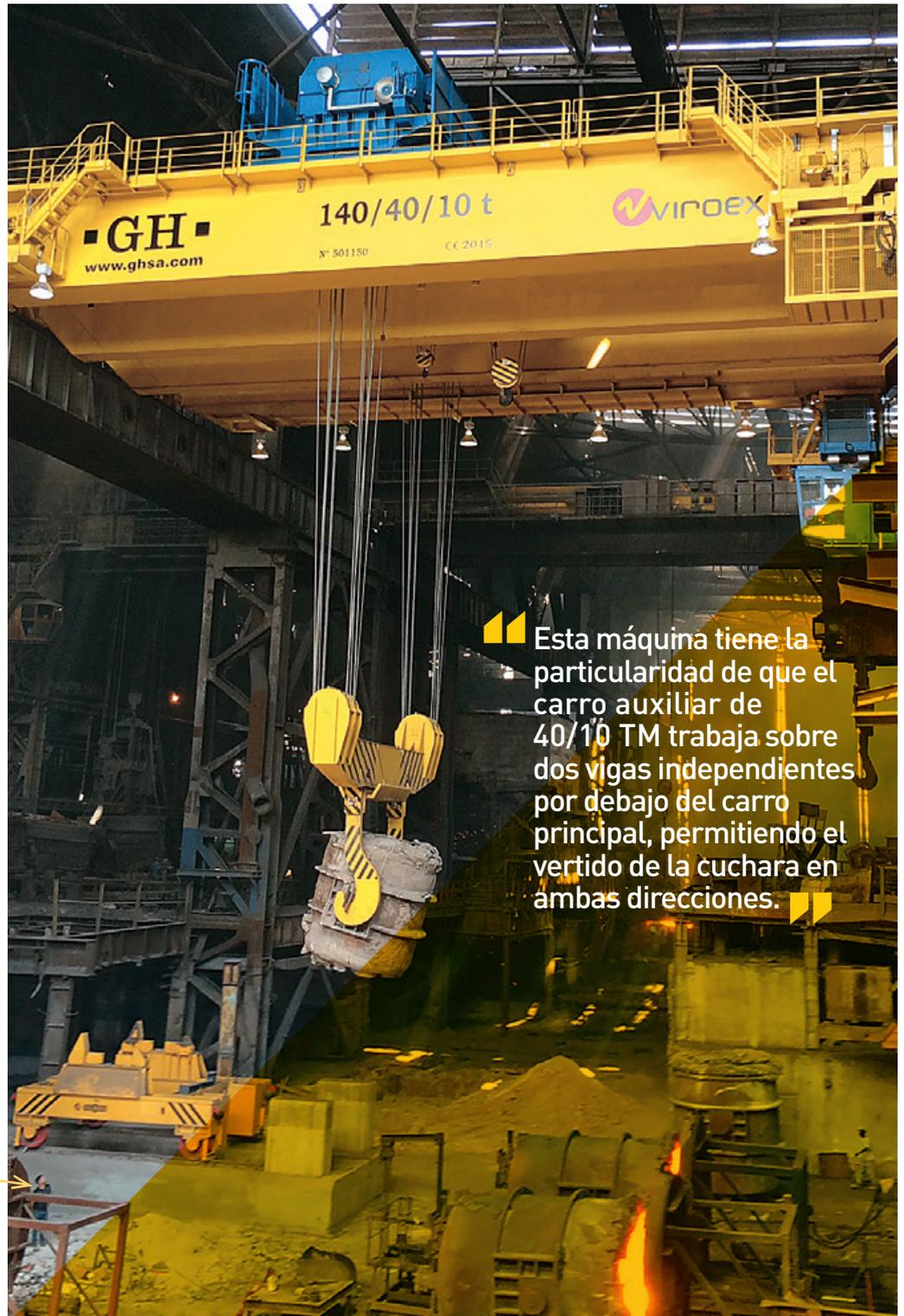
Esta máquina tiene la particularidad de que el carro auxiliar de 40/10 TM trabaja sobre dos vigas independientes por debajo del carro principal, permitiendo el vertido de la cuchara en ambas direcciones.
