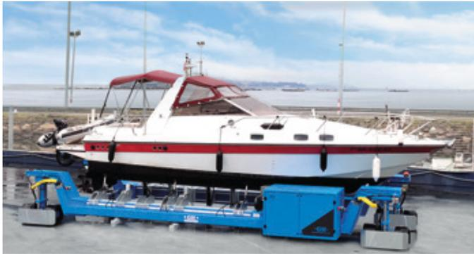
Ce système permet le déplacement des bateaux en cale sèche, aussi bien pour des tâches de stockage dans la zone de halage que pour des entretien et de la maintenance.
