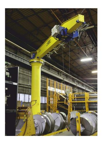
A partir de 500 kg jusqu'à 20 T, elles représentent une solution idéale pour la manipulation des charges dans une zone circulaire proche du poste de travail.
